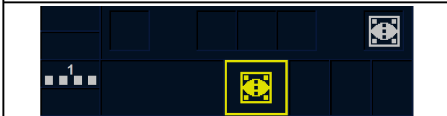
Bild 49: Aufforderung zum Bestätigen des vollzogenen (nicht angekündigten) Wechsels in die ETCS-Betriebsart LS
