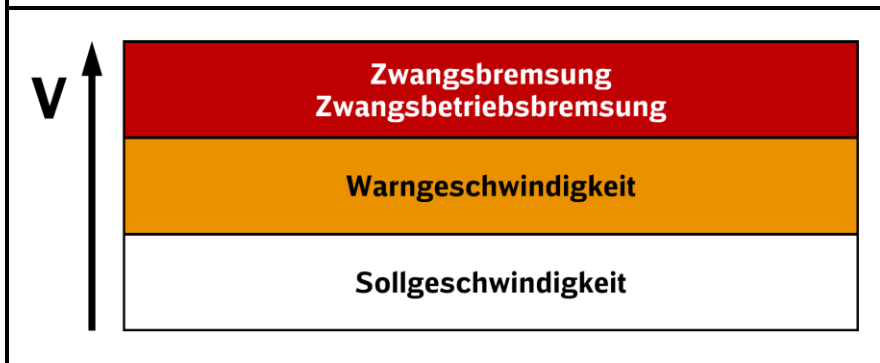
Bild 3: Grundsätzliche Farbdarstellung des Tachokreises am Beispiel einer Überschreitung der V_{\text{soll}}
