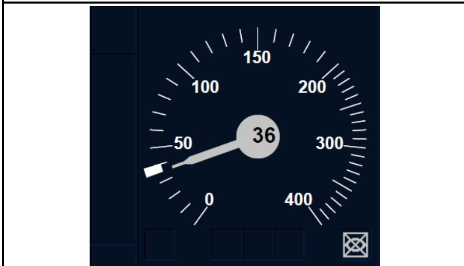
Bild 60: Beispiel einer Fahrt in ETCS-Level 2 in der ETCS-Betriebsart SR (mit eingeblendeten Überwachungsgrößen)
