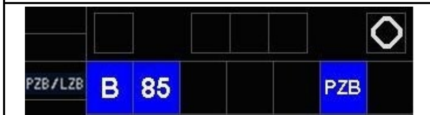
Bild 44: ETCS-Betriebsart SN wirksam (ETCS-Level NTC PZB/LZB) *
