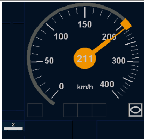
Bild 24: Anstoß an die Zwangsbetriebsbremskurve
