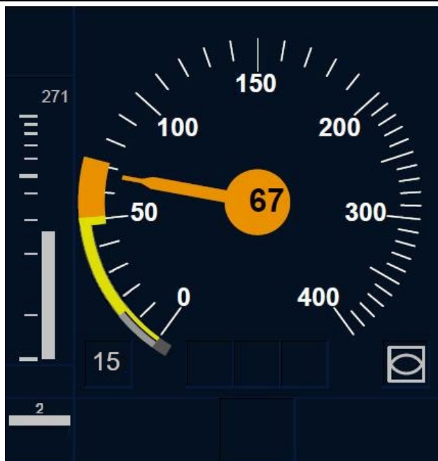
Bild 21: Anstoß an die Zwangsbremskurve
